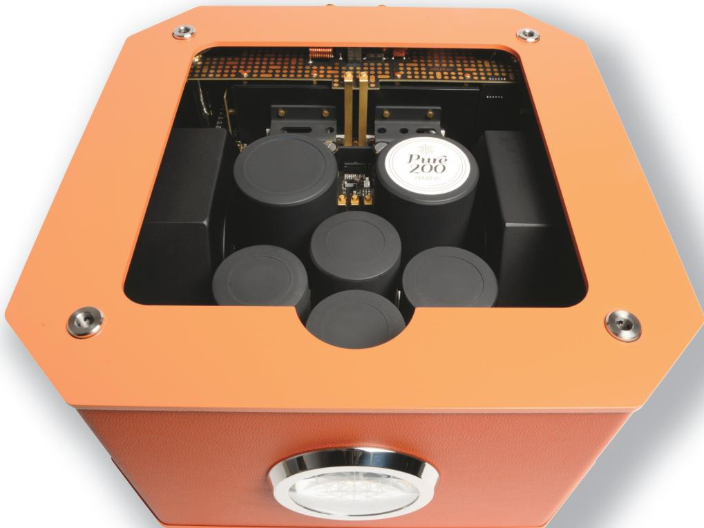
**Les 2 transfos de 550 VA chacun encadrent les capacités totalisant 360 000  $\mu$ F, purgées à l'extinction pour les préserver et éviter un effet mémoire. On distingue les bus dorés, toutes les cartes électroniques ayant une finition nickel/or électrolytique ; les diodes ultrarapides ont un temps de recouvrement de 35 ns. Le taux de réjection de l'alimentation est de -90 dB et les étages de sortie possèdent une résistance interne très faible.**
